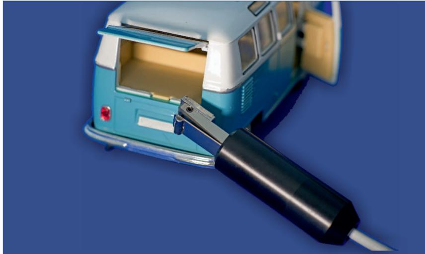
Die Karosseriemessung ist ein komplettes System zum Kontrollieren der Eigenschaften: Schachtmaß, Spaltmaß und Bündigkeit der Karosserie.
